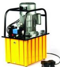
**Электрическая гидравлическая насосная станция Риклайн НЭР2/70-5/0,7А8Ф2** - предназначена для нагнетания гидравлического масла в различные механизмы, работающие от гидравлического привода в условиях умеренного климата.
