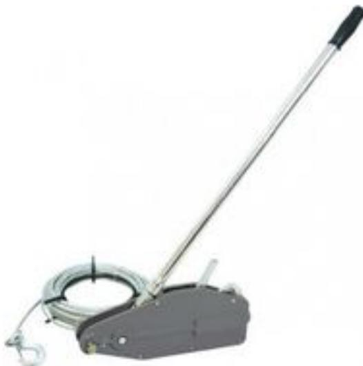
Ручная лебедка **Риклайн** более известна как **МТМ** (монтажно-тяговый механизм) - оборудование, предназначенное для выполнения подъемных и тяговых работ при демонтаже, а также для спуска грузов, натяжки и растяжки.
