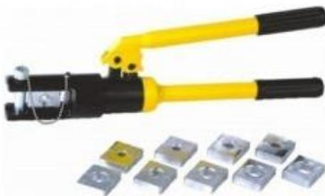
Предназначены для окольцовки и соединения кабелей, проводов методом опрессовки соответствующими наконечниками, гильзами. В основу опрессовки положен принцип деформирования материала контактной пары жила-наконечник(гильза) с образованием зоны контактирования между ними. Форма деформирования и степень деформации определяется набором матриц и пуансонов, входящих в комплект пресса.
