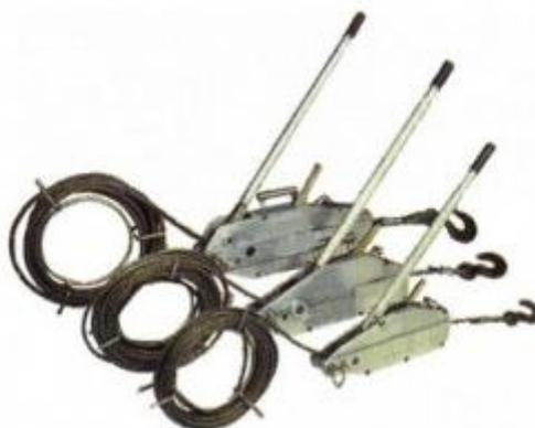
Предназначены для выполнения подъемных и тяговых работ, а также для спуска грузов, натяжки и растяжки. Принцип работы монтажно-тягового механизма основан на протягивании каната через тяговый механизм с помощью двух пар зажимов, которые попеременно сжимают канат с усилием, пропорциональным нагрузке, и продвигают его в соответствующем направлении.
